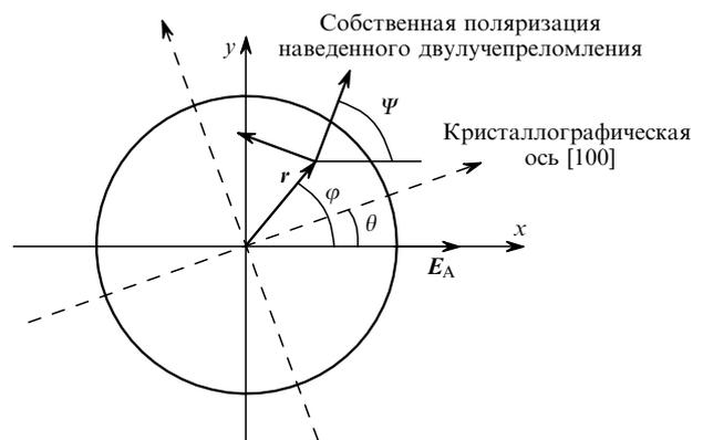
Рис. 2. Схема сечения магнитоактивного кристалла.
