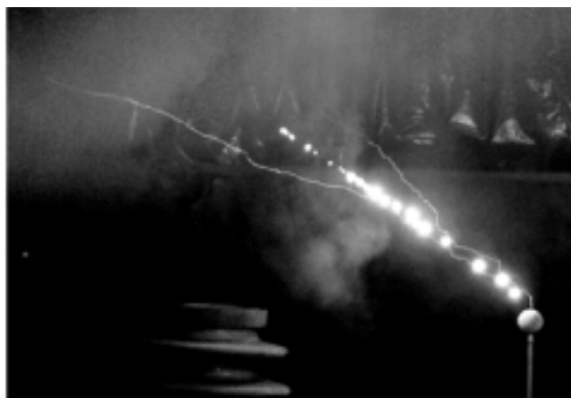
Рис.2. Фотография разряда с лазерной искрой в промежутке.
