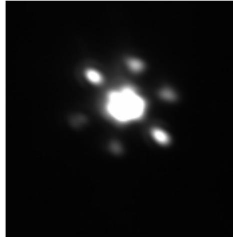
Рис.2. Распределение интенсивности излучения титан-сапфирового лазера на выходе микроструктурированного волокна с одним гексагональным циклом воздушных отверстий вокруг сердцевины диаметром 2 мкм.
