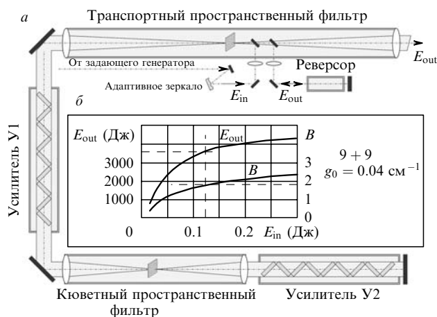
Рис.1. Схема установки «Луч» (а) и расчёты выходной энергии и B -интеграла (б).
