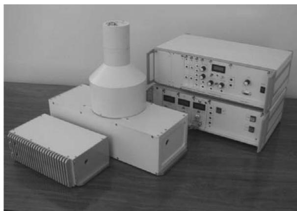
Рис.9. Внешний вид транспортируемого стандарта частоты на базе Nd:YAG/I<sub>2</sub>-системы.
