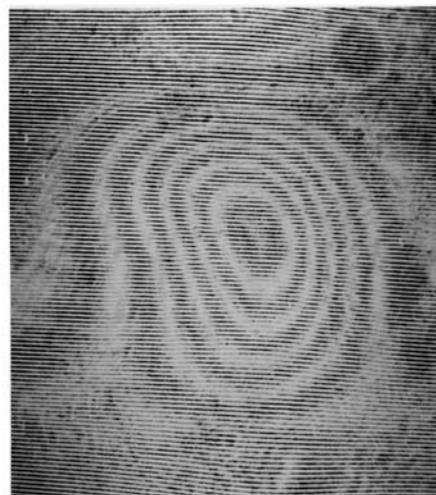
Рис.3. Муаровая картина, визуализирующая в реальном времени с двукратным увеличением чувствительности искажения фазы зондирующей волны при прохождении через исследуемую пластину из полиметилметакрилата.
