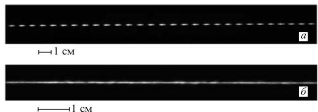
Рис.1. Фотоснимки движущегося в аргоне ОПР: свечение отдельных лазерных искр при  $f = 25$  кГц и  $V_0 = 260$  м/с (а) и свечение непрерывного плазменного канала при  $f = 25$  кГц и  $V_0 = 75$  м/с (б). Затвор фотоаппарата работает в режиме ручной выдержки. Излучение падает слева направо, фокус и ОПР движутся ему навстречу.
