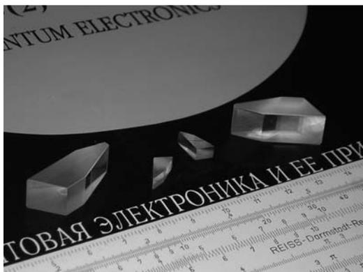
Рис.11. Фотография IV-призм из кальцита с просветлёнными нормальными гранями, изготовленных для работы с пучками диаметром 5 и 9 мм. Цена деления шкалы линейки 1 мм.
