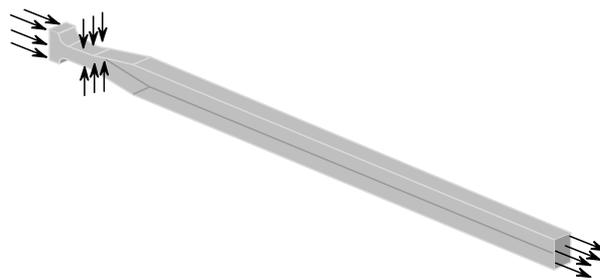
Рис.3. Геометрия расчетной области (наклонные стрелки – первичный поток газа, вертикальные – вторичный).
