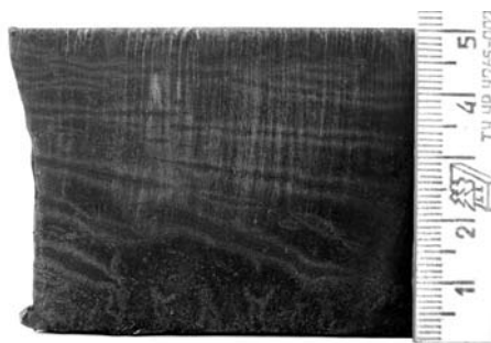
Рис.3. Поверхность реза листа углеродистой стали толщиной 50 мм.
