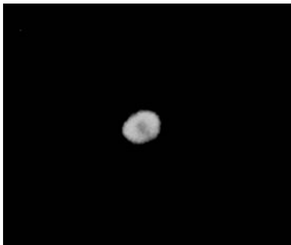
Рис.8. Пятно излучения второй гармоники. Темная область в центре пятна обусловлена термолинзой.
