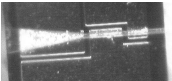
Рис.1. Фотография использовавшейся в экспериментах трехсекционной лазерной структуры с расширяющейся активной областью.
