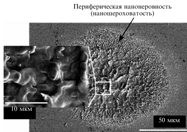
Рис.2. СЭМ-изображение поверхности меди после облучения двумя лазерными импульсами (длительность 65 фс, плотность энергии F = 9.6 Дж/см 2 ). На вставке показаны детали микроструктур в центральной части пятна облучения.
