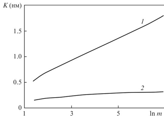
Рис.14. Зависимости среднеквадратичного отклонения в вычисленных длинах волн от числа точек в окне усреднения для переходного процесса (1) и для стационарного состояния сенсора (2).
