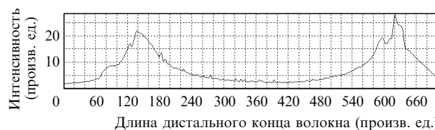
Рис.1. Диаграмма распределения интенсивности света, рассеянного дистальным концом кварцевого волокна после обработки плавиковой кислотой.
