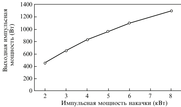
Рис.7. Зависимость выходной импульсной мощности лазера от импульсной мощности СВЧ накачки (лазерный излучатель Б). Смесь \text{CO}_2 : \text{N}_2 : \text{He} : \text{Xe} = 3 : 3 : 13 : 1 при давлении 50 Тор, скорость прокачки рабочей смеси газа \sim 0.1 л/с. Длительность импульсов накачки 20 мкс, частота их следования 400 Гц.
