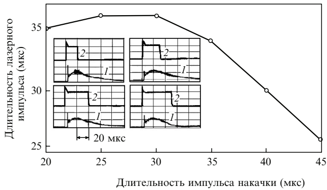
Рис.3. Зависимость длительности импульса лазерного излучения (по попувысоте) от длительности импульса накачки. На вставке – осциллограммы импульсов лазерного излучения (1) и огибающие радиоимпульсов СВЧ накачки (2). Давление газа 30 Тор, частота следования импульсов 500 Гц.
