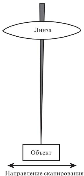
Рис.2. Схема параллельного сканирования предметного столика в плече образца оптического когерентного томографа.
