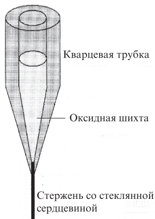
Рис.1. Схема получения заготовки с использованием технологии PIT.
