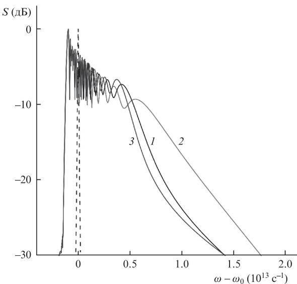
Рис.2. Спектр ударной волны при укручении переднего фронта импульса, прошедшего через волновод длиной 10 м с параметрами  $R = 0.05 \text{ Вт}^{-1}\cdot\text{м}^{-1}$ ,  $\mu = -10^{-14} \text{ Вт}^{-1}\cdot\text{м}^{-1}\cdot\text{с}$ ,  $D = 0 (I)$ ,  $-7 \times 10^{-26} (2)$  и  $5 \times 10^{-26} \text{ с}^2\cdot\text{м}^{-1} (3)$ . Штриховая кривая – спектр начального импульса.
