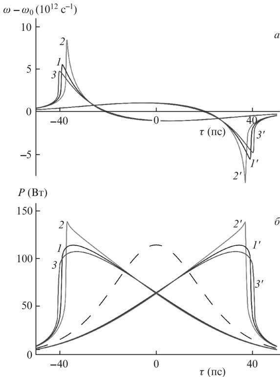
Рис.1. Образование ударной волны: изменение мгновенной частоты (а) и огибающие импульсов (б) после распространения в волноводе длиной 10 м с параметрами  $R = 0.05 \text{ Вт}^{-1}\cdot\text{м}^{-1}$ ,  $\mu = -10^{-14} (I-3)$  и  $10^{-14} (I'-3')$   $\text{Вт}^{-1}\cdot\text{м}^{-1}\cdot\text{с}$ ,  $D = 0 (I, I')$ ,  $-7 \times 10^{-26} (2, 2')$  и  $5 \times 10^{-26} \text{ с}^2\cdot\text{м}^{-1} (3, 3')$ . Штриховая кривая – огибающая начального импульса.
