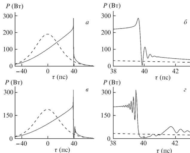
Рис.4. Результаты моделирования распространения импульса в волноводе с параметрами  $R = 0.03 \text{ Вт}^{-1}\cdot\text{м}^{-1}$ ,  $D = -1.5 \times 10^{-25} \text{ с}^2\cdot\text{м}^{-1}$ ,  $\mu = 10^{-14} \text{ Вт}^{-1}\cdot\text{м}^{-1}\cdot\text{с}$ ,  $l = 6.6$  (а, б) и  $7.5$  м (в, г). Штриховые кривые – огибающие начального импульса.
