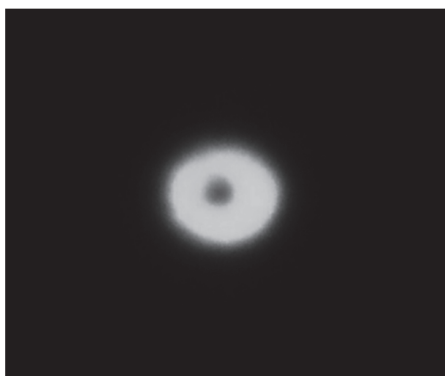
Рис.8. Форма пятна непоглощенного излучения накачки, наблюдаемого с помощью люминесцентного визуализатора ИК излучения на выходе преобразователя.
