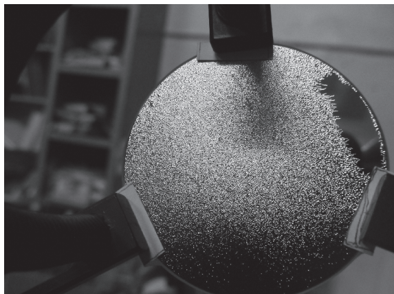
Рис.3. Отслоение многослойной структуры в МЗ (первый слой на кварцевой подложке – сурьма).
