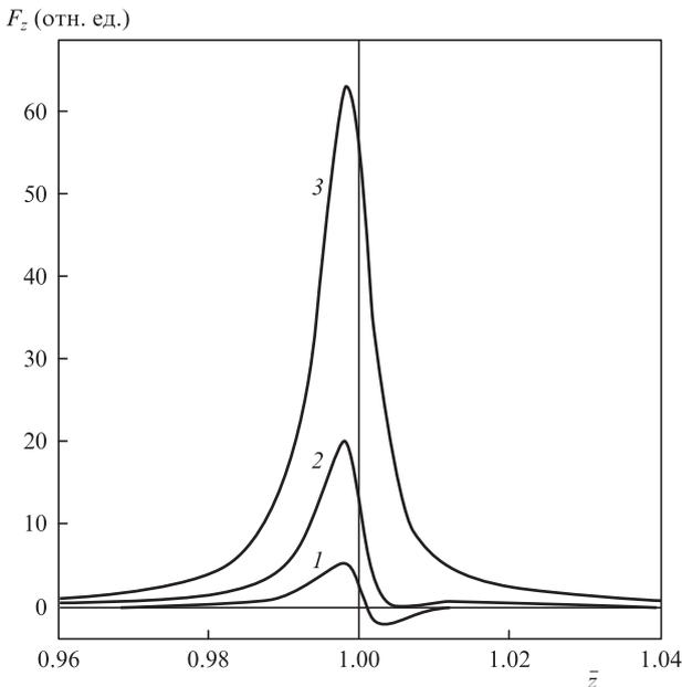
Рис.4. Зависимости нормированной результирующей силы  $F_z$  от  $\bar{z} = z/f$  при радиусах наночастицы  $a = 10$  (1), 13.6 (2) и 17.1 нм (3).
