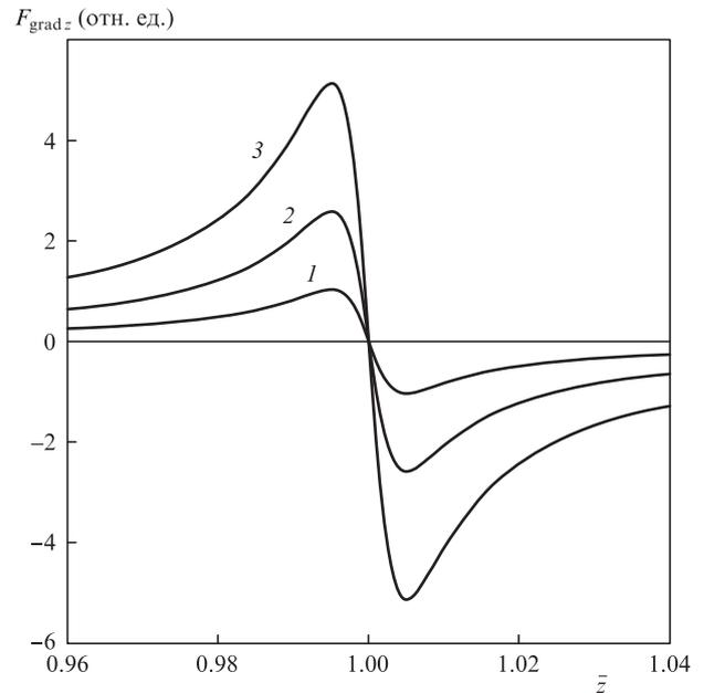
Рис.3. Зависимости нормированной продольной компоненты градиентной силы  $F_{\text{grad}z}$  от  $\bar{z} = z/f$  при радиусах наночастицы  $a = 10$  (1), 13.6 (2) и 17.1 нм (3).
