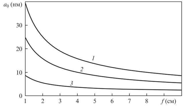
Рис.5. Зависимости предельного радиуса наночастицы  $a_0$  от фокусного расстояния линзы  $f$ , рассчитанные из условия  $\Gamma(a_0, f, r_0) = 1$ , при котором результирующая сила  $F_z = 0$ , для  $r_0 = 0.1$  (1), 0.05 (2) и 0.01 см (3).
