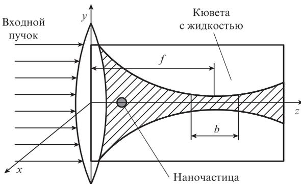
Рис.1. Схема фокусировки пучка тонкой линзой с фокусным расстоянием  $f$  в кювету с жидкостью, в которую погружена наночастица;  $b$  – конфокальный параметр.
