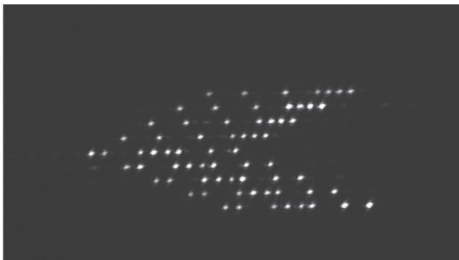
Рис.10. Изображение тест-объекта в виде фрагмента страницы входных данных, восстановленное с одиночной одномерной субголограммы Фурье.
