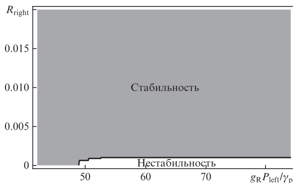
Рис.5. Карта динамических режимов при отражении волн на левом торце волокна.
