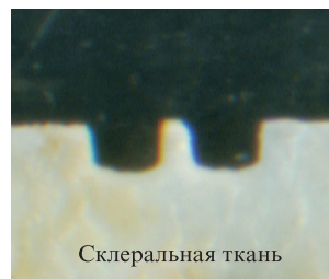
Рис.2. Профиль каверны, оставаемой лазерным излучением с \lambda = 308 нм в склеральной ткани глаза.
