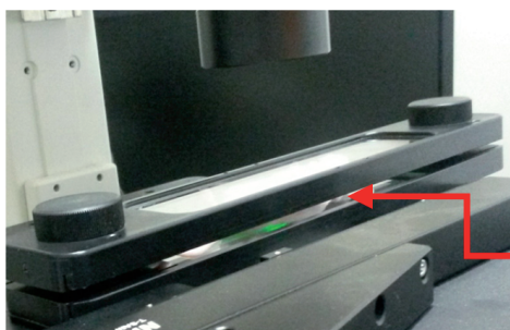
Рис.7. Схема экспериментальной установки для визуализации распределения интенсивности флуоресценции, дополнительный детектор 2 служит для одновременных исследований на второй длине волны (а), функциональная схема экспериментальной установки (б), подвижный столик микроскопа с кассетой, содержащей животное (в), и увеличенное изображение мыши внутри кассеты, стрелка указывает на ксенотрансплантат опухоли (з).
