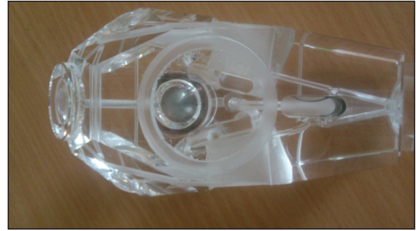
Рис.3. Внешний вид резонатора кольцевого лазера ЧЗЛГ.
