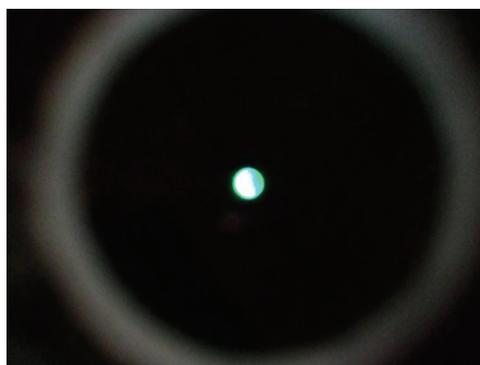
Рис.10. Фотография пучка излучения ТГ ( $\lambda/3 = 520$  нм) при генерации в пленке RR-РЗНТ толщиной 550 нм на подложке и накачке со стороны полимера излучением ближнего ИК диапазона ( $\lambda = 1560$  нм), подводимого к образцу волоконно.
